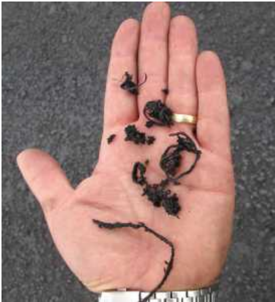
Fotografía Nro. 45, caucho desprendido de los neumáticos por reversión
