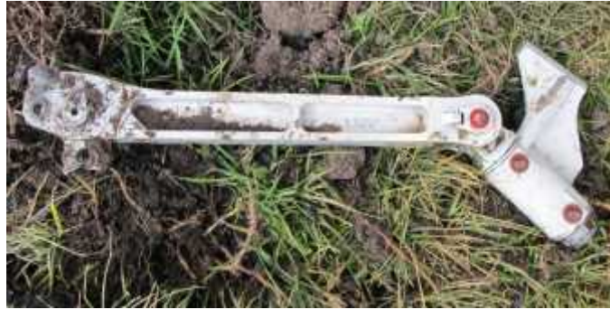
Barra de seguridad del tren principal izquierdo
