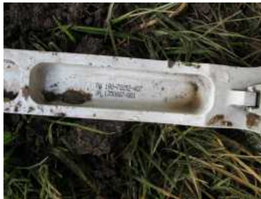
Barra de seguridad del tren principal izquierdo
